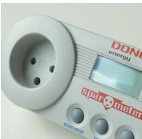
Et sparometer synliggør dit energiforbrug.
